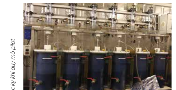
1. Bình phản ứng 1000ml; 2. Ống dẫn khí; 3. Khóa; 4. Thang đo thể tích khí; 5. Bể chứa dung dịch NaCl; 6. Thiết bị gia nhiệt; 7. Bể chứa H 2 O
